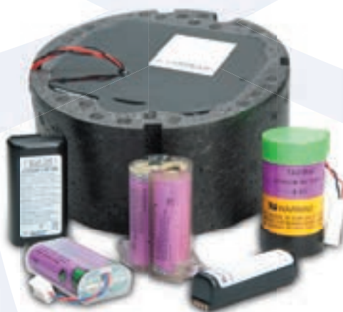
Рис.2 По запросу возможно проектирование, производство и тестирование батарейных сборок согласно требованиям заказчика.
