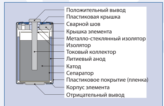
Рис. 1 Устройство литиевой батареи.
