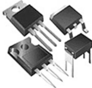
В первом случае **полевые транзисторы** имеют не очень хорошие токи утечки и сравнительно небольшие пробивные напряжения, но при этом их удобно использовать в линейном режиме.
