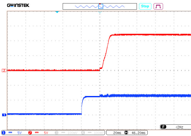
Рис. 35. Установление U_{\text{вых.ном}} с момента подачи ДУ (соединение выводов «ВКЛ» и «-ВХ»).
