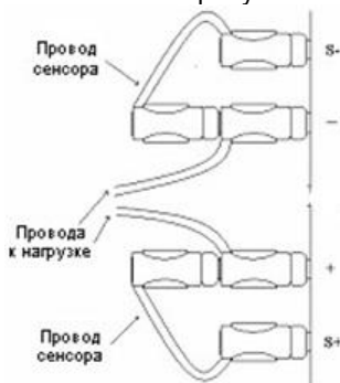
Рис. 7.1 Схема подключения удаленной нагрузки
