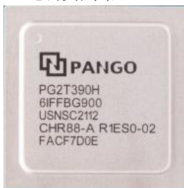
图 2-2-1 FPGA 芯片实物
