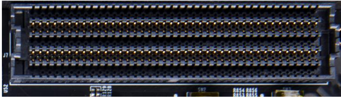
图 2-13-2 FMC 连接器实物图
