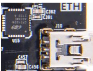
图 2-12-2 USB 转串口实物图
