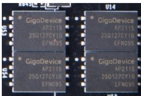
图 2-5-2 QSPI FLASH 部分实物图
