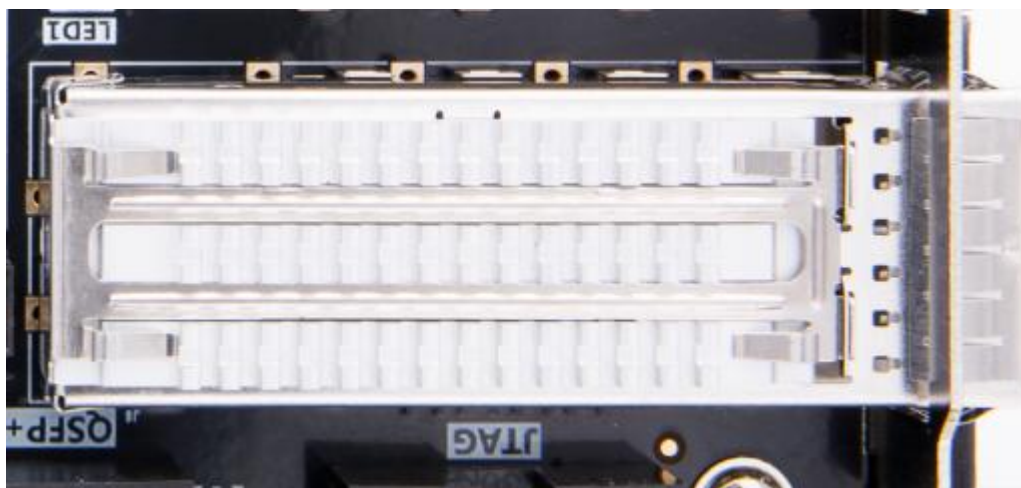
图 2-8-2 QSFP+光纤通信接口实物图
