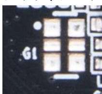
图 2-2-4 100M 差分晶振
