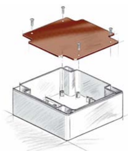
Стандартное крепление монтажных плат, частично, есть и в крышке.
