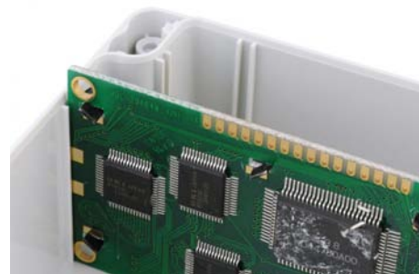
LP-версия: С пазами для вставки печатных плат в нижней части
