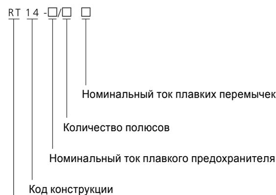
Плавкий предохранитель с наполненным порошком картриджем
