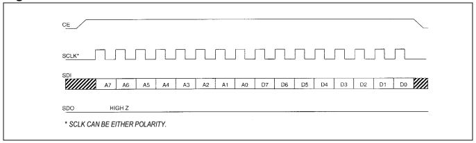
Figure 7. SPI SINGLE-BYTE READ
