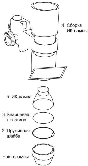
Рисунок 7 (схема разбора ИК-лампы)
