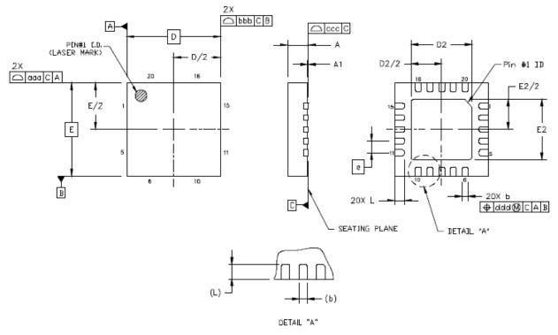
Figure 25. 20-Pin Quad Flat No-Lead (QFN)
