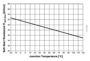
Figure 39 Soft-Start Resistance  $R_{Soft-Start}$  vs.  $T_j$
