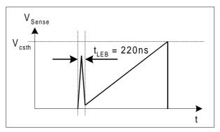
Figure 13 Leading Edge Blanking
