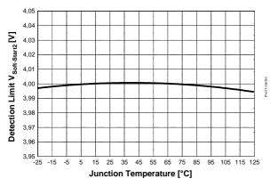
Figure 42 Detection Limit  $V_{Soft-Start2}$  vs.  $T_j$
