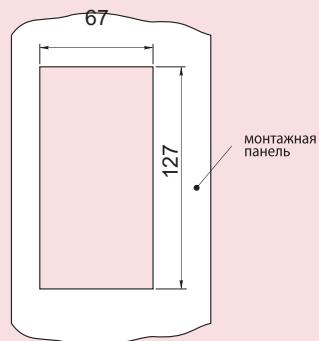
\* Толщина монтажной панели ≤1,5 мм.
