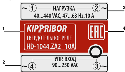
Рисунок 2 – табличка для серии HD-●●44.ZD3[M01] / ZA2[M01]
