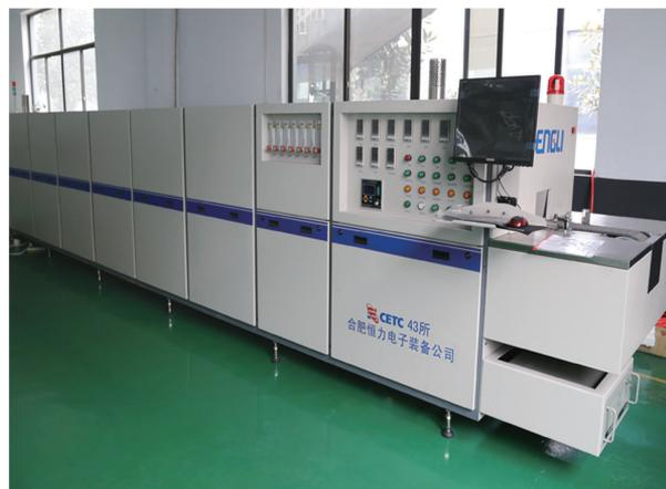
隧道烧接炉
