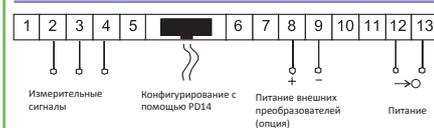
Рис. 5. Схема электрических соединений для приборов N24Z и N24H для измерения тока
