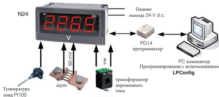
Измерение и отображение:
