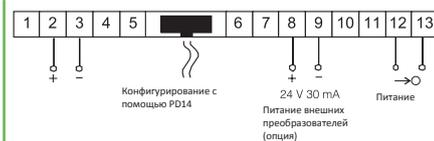
Рис. 1. Схема электрических соединений для приборов N24S
