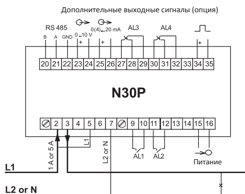
Рис. 1 Схема электрических соединений прибора N30P для прямых измерений.
