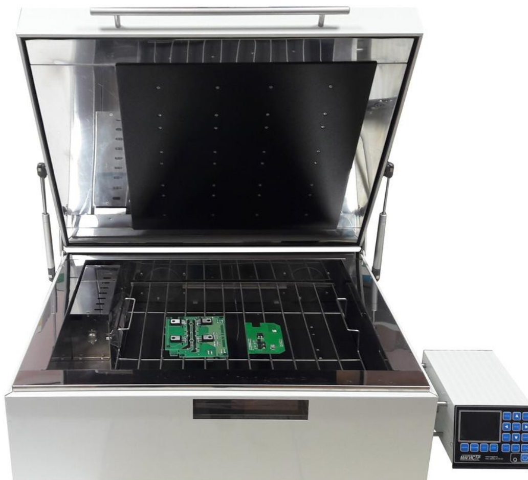
Фото 4. Размещение плат в нагревательной камере
