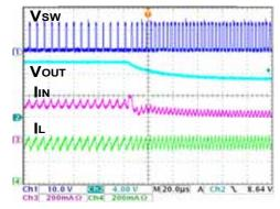
Fig. 83. Short-circuit protection
