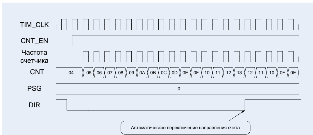
Рисунок 66 – Диаграммы работы таймера, счет вверх/вниз, сначала вверх
