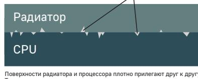
Поверхности радиатора и процессора плотно прилегают друг к другу. Термопаста занимает только неровности в этих поверхностях.
