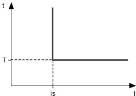
Рисунок 3.1 – Принцип защиты с независимой выдержкой времени
