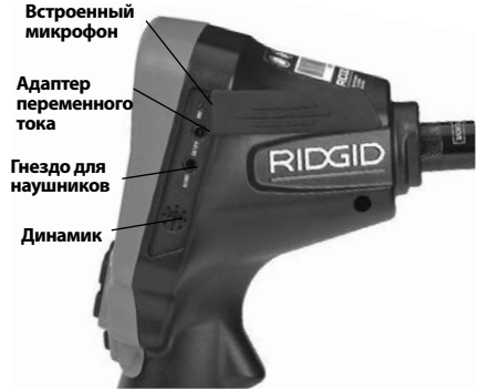
Рис. 3 - Крышка гнезд с правой стороны прибора
