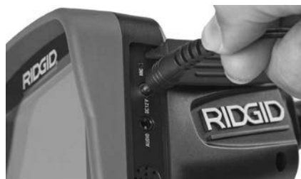
Рис. 6 - Питание прибора от адаптера переменного тока
