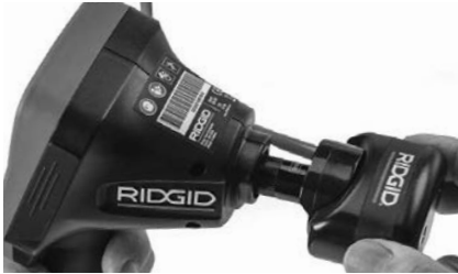
Рис. 18 - Вилка разъема видеокамеры подключена
