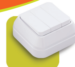
451A5 Выключатель трёхклавишный 1 вход 3 выхода Напряжение 250 V~ Сила тока 10 AX Степень защиты IP20
