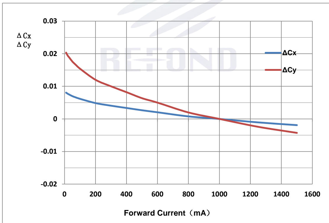
Fig. 1-14 Chromaticity Coordinate Shift Vs Forward Current 色坐标偏移与正向电流特性曲线
