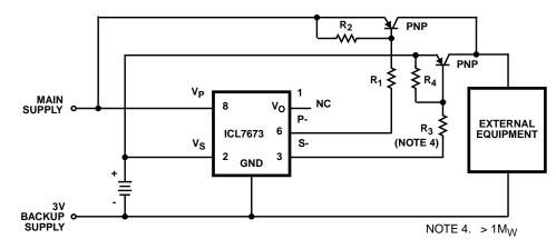
FIGURE 11. HIGH CURRENT BATTERY BACKUP SYSTEM
