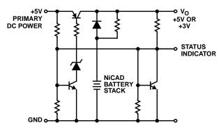
FIGURE 6. DISCRETE BATTERY BACKUP CIRCUIT
