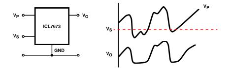
FIGURE 14. CLIPPLING CIRCUITS
