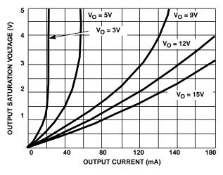
FIGURE 4. P<sub>BAR</sub> OR S<sub>BAR</sub> SATURATION VOLTAGE AS A FUNCTION OF OUTPUT CURRENT
