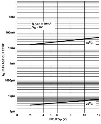
FIGURE 5. I<sub>S</sub> LEAKAGE CURRENT V<sub>P</sub> TO V<sub>S</sub> AS A FUNCTION OF INPUT VOLTAGE
