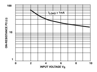
FIGURE 2. ON-RESISTANCE SWITCH P2 AS A FUNCTION OF INPUT VOLTAGE  $\mathrm{V}_{\mathrm{S}}$
