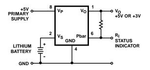
FIGURE 7. ICL7673 BATTERY BACKUP CIRCUIT
