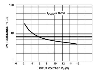
FIGURE 1. ON-RESISTANCE SWITCH P1 AS A FUNCTION OF INPUT VOLTAGE  $V_{\mbox{P}}$
