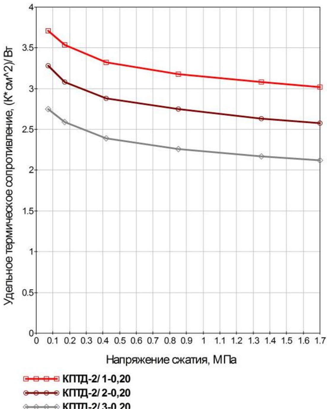
Следует отметить, что за счет конформной поверхности и эластичности термическое сопротивление материалов КПТД-2 стабилизируется уже при напряжении сжатия 0,5-0,7 МПа. При напряжении сжатия до 3,5 МПа изменение толщины материала КПТД-2 за счет сжатия с достаточной точностью возможно рассчитать по формуле 5. При применении одностороннего липкого слоя или позиционирующей смазки суммарное удельное контактное термическое сопротивление уменьшается.
