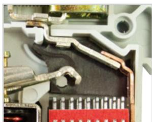
**Антипригарная пластина** защищает корпус аппарата от прогорания при коротких замыканиях.
