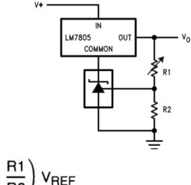
$$V_{O} = \left(1 + \frac{RT}{R2}\right) V_{REF}$$
