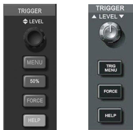
Рисунок 1-11. Зона управления запуском на панели управления осциллографов с 5,7-дюймовым дисплеем (слева) и 7-дюймовым дисплеем (справа)
