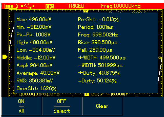
Рисунок 4-17(а). Измерение полного набора параметров в осциллографе UTD1000CL
