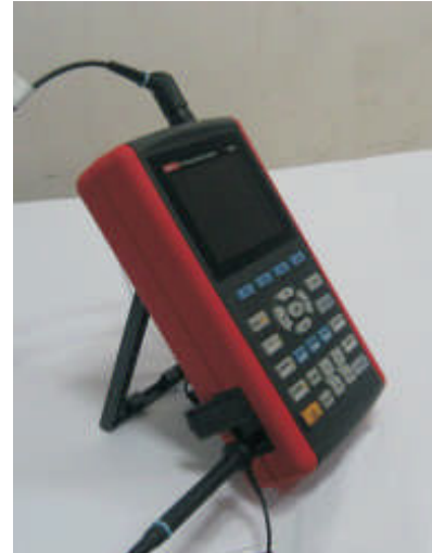
Рисунок 3-2. Подключение к выходу компенсации щупа
