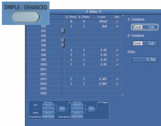
Пример: Экран настройки триггера "А задержка В" (А delay В) (После того, как условие А станет истинным, триггер запускается, когда условие В по прошествии заданного времени станет первый раз истинным).
