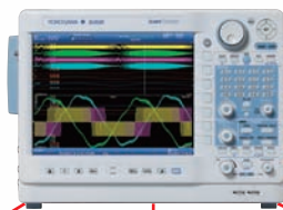
Пример: Экран настройки триггера "А задержка В" (А delay В) (После того, как условие А станет истинным, триггер запускается, когда условие В по прошествии заданного времени станет первый раз истинным).
