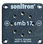
Имеют встроенный генератор, Упит. 1.5 ÷ 15 В DC. Частота звука легко устанавливается подключением внешнего конденсатора к третьему выводу. Диапазон частот 50...2500 Гц, макс. интенсивность звука 90 дБ, диапазон рабочих температур: -40...+85°C.
