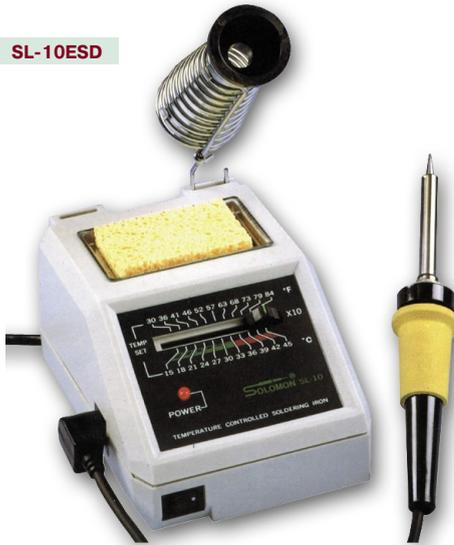
Предназначены для пайки при поддержании постоянной температуры жала паяльника в пределах от 150 до 420°C с точностью 2–3°C. Точность обеспечивается температурным датчиком, расположенным в корпусе нихромового проволочного нагревательного элемента рядом с жалом паяльника, и электронно-цифровой системой регулирования температуры основного блока.
